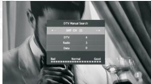
**Примечание:** Полоска сигнала показывает качество сигнала. После ручного поиска, DA100D воспроизводит новые каналы автоматически.
